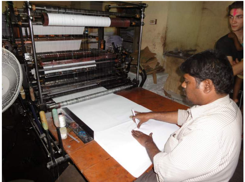
Manuelle Papierzufuhr auf einer Linien-Druckmaschine
